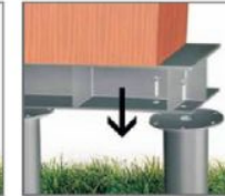
横梁サポートシステム 鋼材を使用したプレート形状に適しています。
